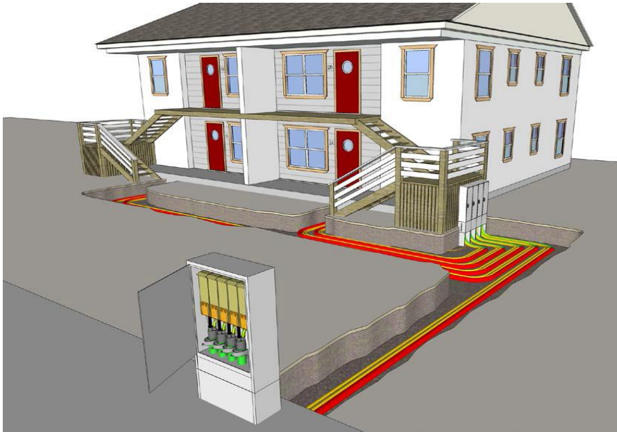
Figur 1.6-1 - Stikkledning til frittstående tilknytningsskap med 4 felter
